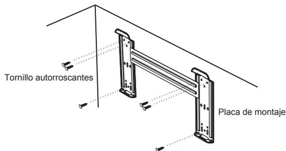
**Nota:** La forma de su placa de montaje puede ser diferente de la arriba mencionada, pero el método de instalación es similar.
