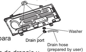
Simply instale el puerto de drenaje y la arandela de caucho al chasis de la unidad externa, luego conecte una manguera de drenaje al puerto como se muestra en la figura derecha.
