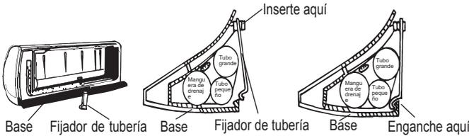
A. Inserte el fijador de tubería en la ranura.
