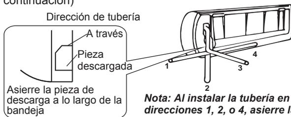
**Nota:** Al instalar la tubería en las direcciones 1, 2, o 4, asierre la pieza descargada correspondiente desde la base de la unidad interna.
